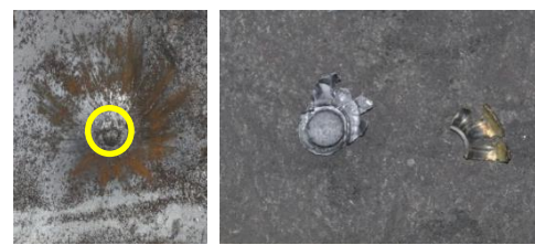
ภาพที่ 6 ความเสียหายที่แผ่นโลหะและลูกกระสุนหมายเลข 4
