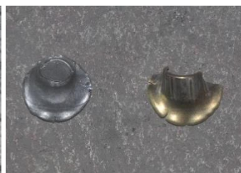
ภาพที่ 19 ความเสียหายที่แผ่นโลหะและลูกกระสุนหมายเลข 7
