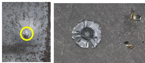
ภาพที่ 5 ความเสียหายที่แผ่นโลหะและลูกกระสุนหมายเลข 3
