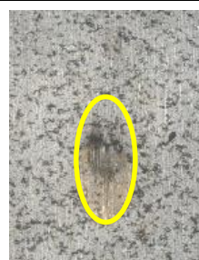
ภาพที่ 22 ความเสียหายที่แผ่นโลหะและลูกกระสุนหมายเลข 10
