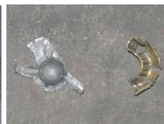
ภาพที่ 16 ความเสียหายที่แผ่นโลหะและลูกกระสุนหมายเลข 4
