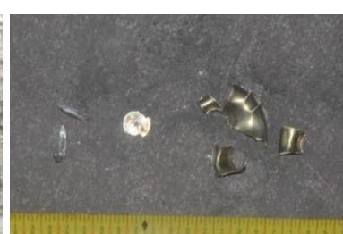
ภาพที่ 18 ความเสียหายที่แผ่นโลหะและลูกกระสุนหมายเลข 6
